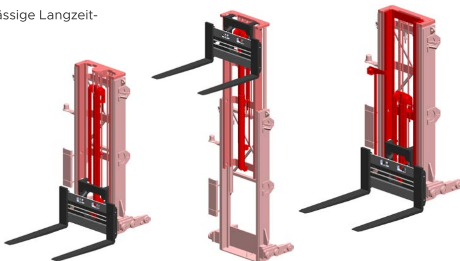
Simplex-Hubgerüst mit Standardfreihub
