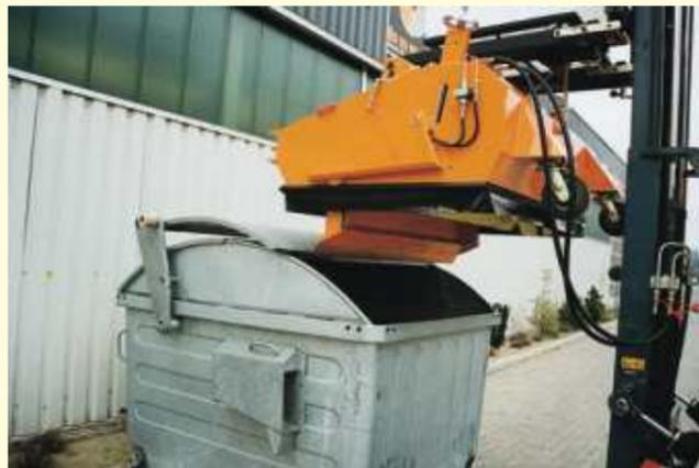
Das Entleeren und Schließen des Schmutzbehälters erfolgt serienmäßig hydraulisch. Als Schmutzaufnahmefähigkeit wird der gesamte vordere Bereich des Maschinengehäuses genutzt. Mit der Hubeinrichtung des Trägerfahrzeuges kann der Schmutzbehälter in Containerhöhe entleert werden.
