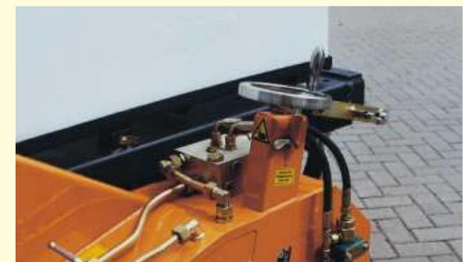
**Gleichmäßiger Anpressdruck der Kehrwalze**
