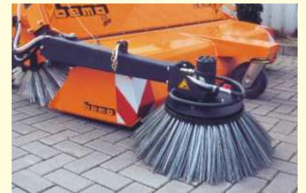
■ Gründliche Reinigung von Rinnsteinen und Gebäudeangrenzungen durch hydraulisch angetriebenen Seitenkehrbesen, neigt sich beim Hochklappen zur Maschinenmitte hin, Schutz vor Beschädigungen
