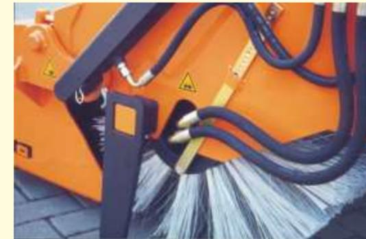
■ Der Gerotormotor ist zum Schutz vor Beschädigungen in die Kehrwalze integriert.
