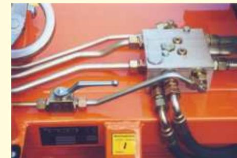
■ Der speziell konzipierte Steuerblock enthält alle notwendigen Aggregate: Überdruckventil, Nachlaufsicherung der Kehrwalze, Umschaltventil für Schmutzsammelwanne, Anschlußmöglichkeit für den Seitenkehrbesen
